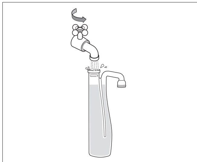
Fig. 16 Umpleți sifonul cu apă
