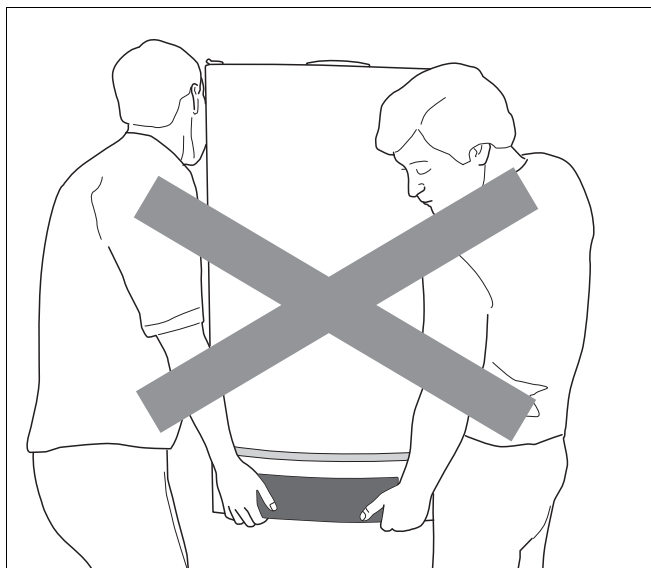
Fig. 3 Ridicarea și transportul incorect al cazanului de încălzire
